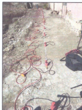
Fig. 5: Vista dello stendimento MASW
