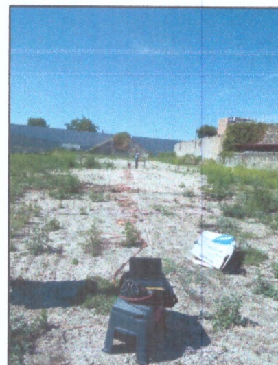
Fig. 5: Vista dello stendimento MASW con disposizione PC e unità di testa
