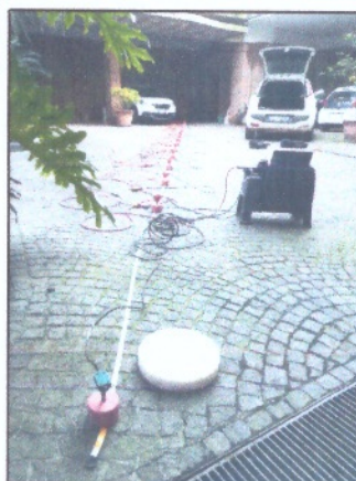
Fig. 5: Vista dello stendimento MASW
