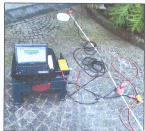
Fig. 6: Postazione di battuta con disposizione PC e unità di testa
