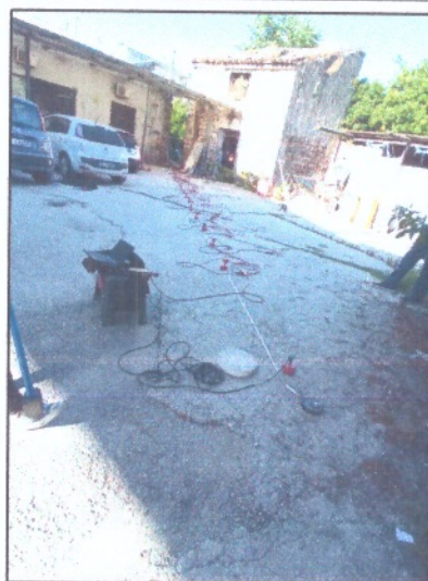
Fig. 4: Vista dello stendimento MASW
