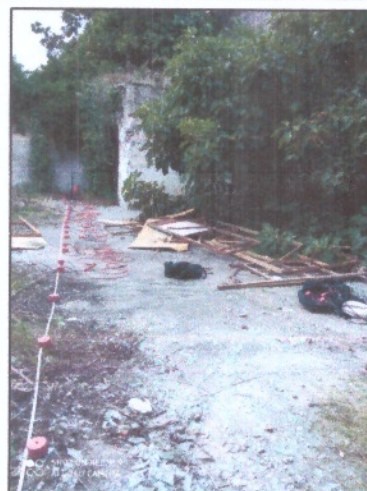
Fig. 5: Vista dello stendimento MASW
