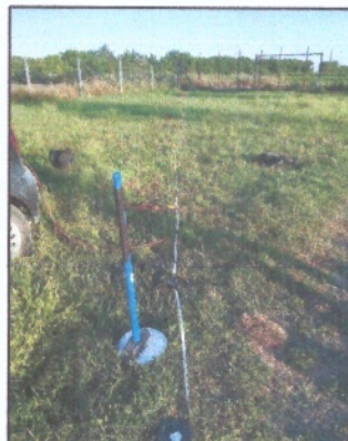
Fig. 5: Vista dello stendimento MASW con postazione di battuta
