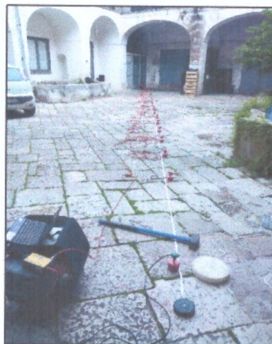
Fig. 5: Vista dello stendimento MASW
