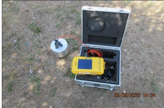
*Fig. 13: Sismografo Vibralog*
